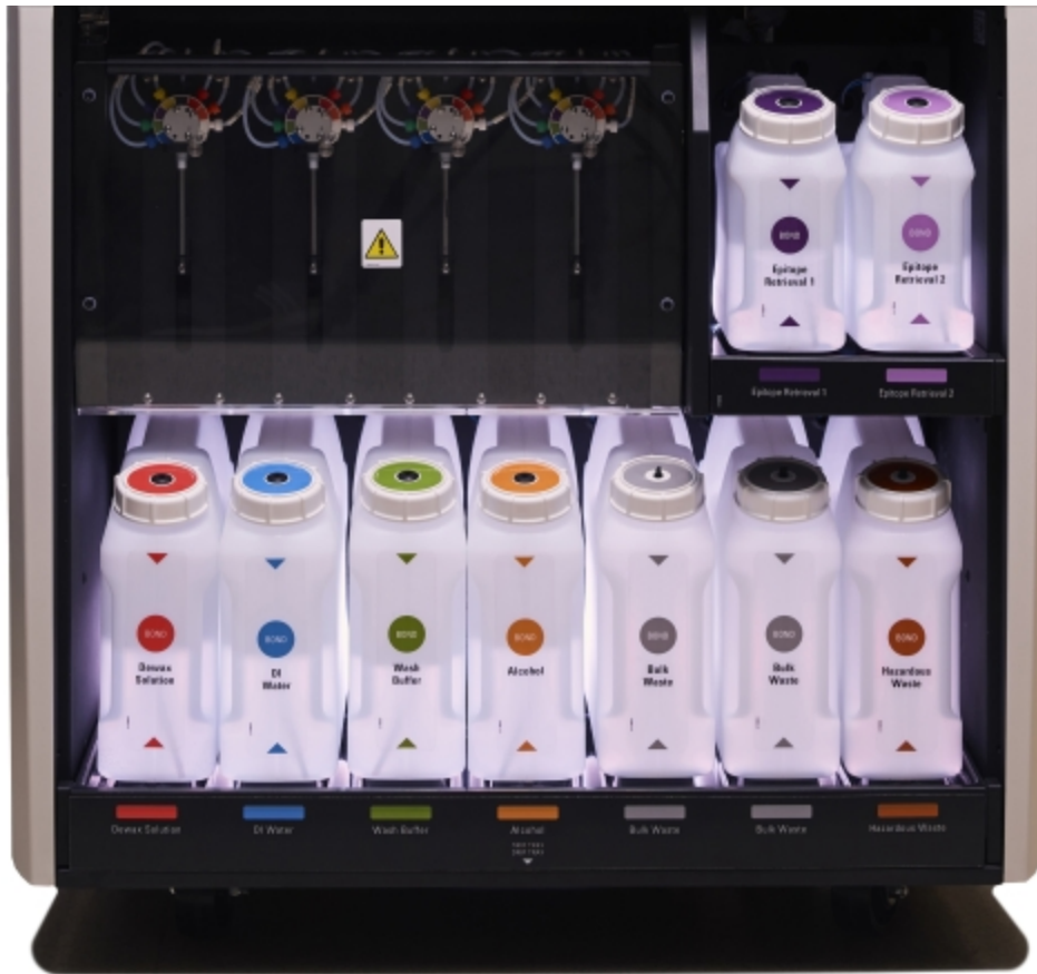
图 2-15:大容器照明系统
