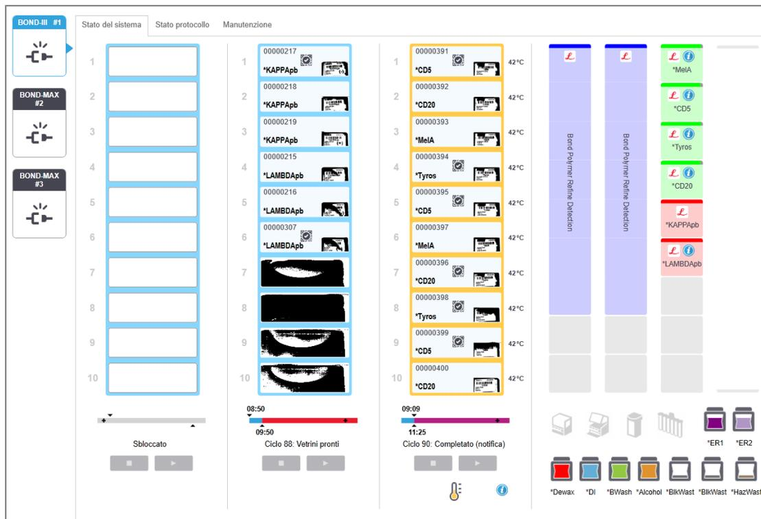
Le Schede modulo di processazione a sinistra delle schermate di stato forniscono una sintesi visiva dello stato del modulo di processazione associato. Fare clic sulla scheda per vedere lo stato del modulo di processazione nel dettaglio.
