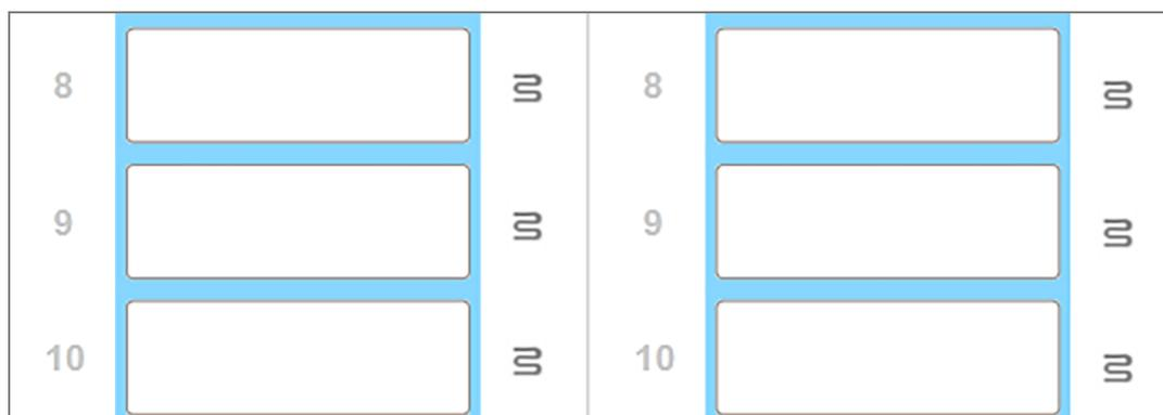
Una volta spento il riscaldamento vetrini, è necessario spegnere e riavviare il modulo di processazione per eliminare il blocco degli elementi riscaldanti. È possibile continuare a utilizzare le posizioni dei vetrini con gli elementi riscaldanti difettosi a condizione che i vetrini processati in quella posizione non richiedano di essere riscaldati.
