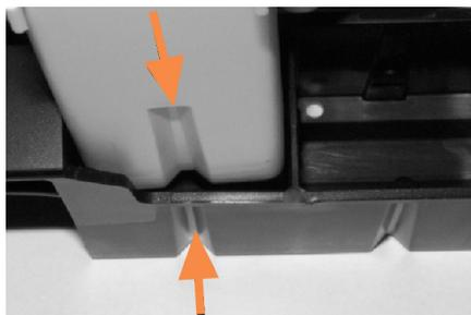
Le frecce indicano le scanalature nel contenitore dei reagenti e nel vassoio reagente.
