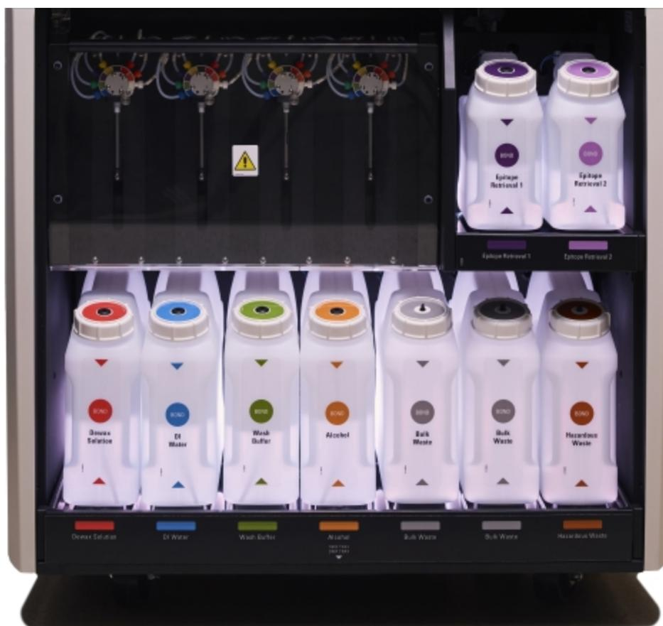
Il sistema di illuminazione per contenitori in bulk aiuta a vedere il livello di liquidi in ogni contenitore e le luci sono di un colore bianco statico durante il normale funzionamento.
