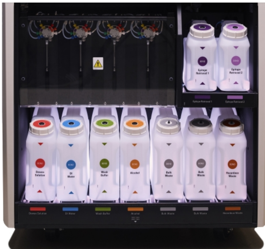
図 2-15: バルク容器照明システム
