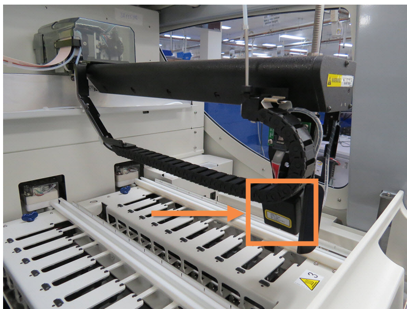
図 2-6: メインロボットとIDイメージャーの写真(矢印で示す)
