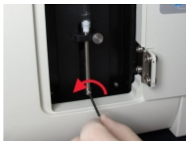
図 12-17: 六角レンチでプランジャーロックねじを緩める
