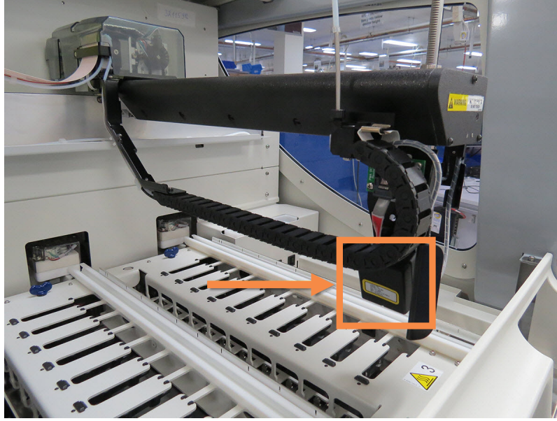
Şekil 2-6: Kimlik görüntüleyici ok ile gösterilen ana robot fotoğrafı
