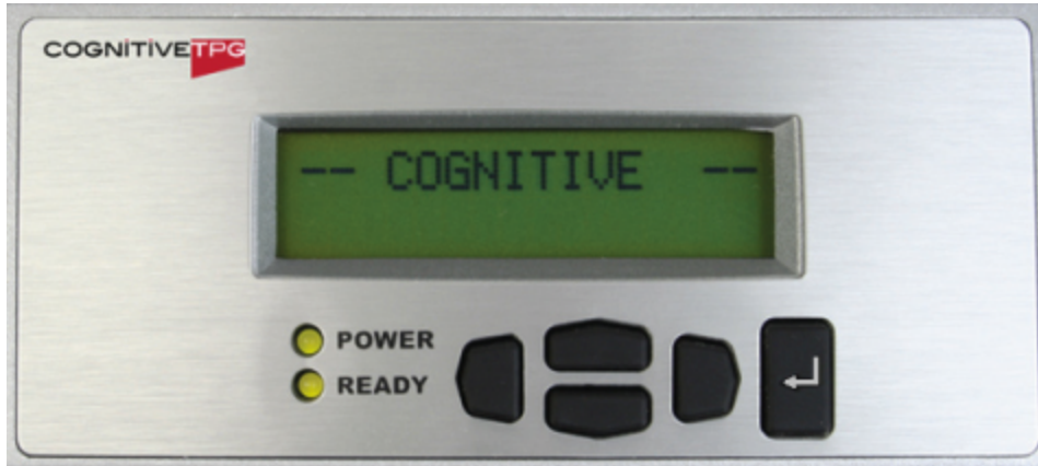
řekil 17-1: Kognitif Yazıcı LCD ekran ve klavye
