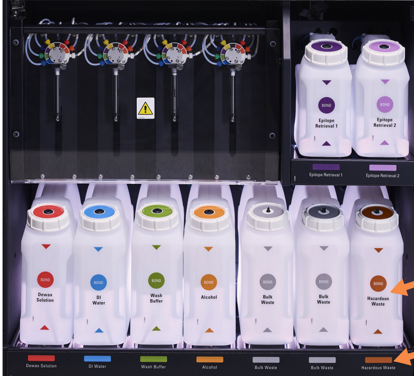
Şekil 2-14: BOND-III kimyasal reaktif konteynırları yerlerinde
