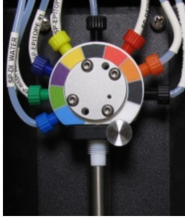
Şekil 2-23: BOND-MAX 9-portlu şırınga
