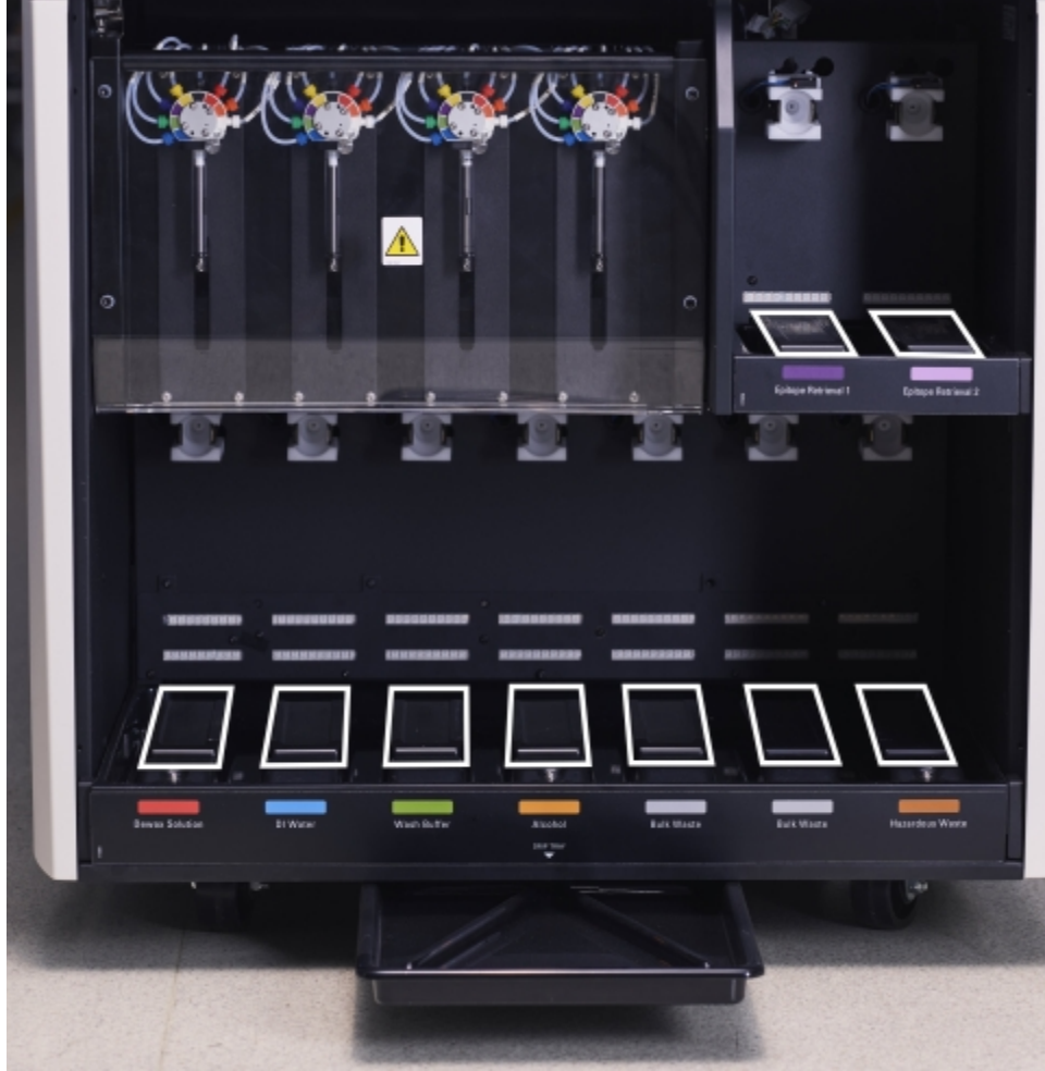
Şekil 12-13: BOND-III bidon damlama tepsileri ağırlık sensörü kapaklarını gösteriyor
