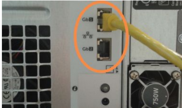
Şekil 16-5: BOND RemoteCare için kullanılan Ethernet portları
