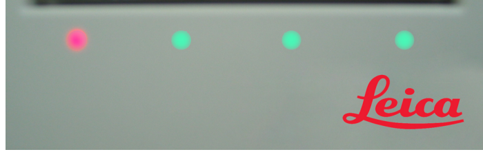
Şekil 2-13: Reaktif tepsisi LED renkleri (kırmızı, yeşil) BOND-MAX cihazı üzerinde
