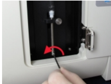
Şekil 12-17: Piston kilit vidasını altıgen anahtarla açma
