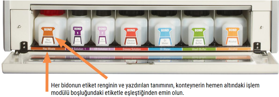
Şekil 2-16: BOND-MAX kimyasal reaktifleri konumlarında
