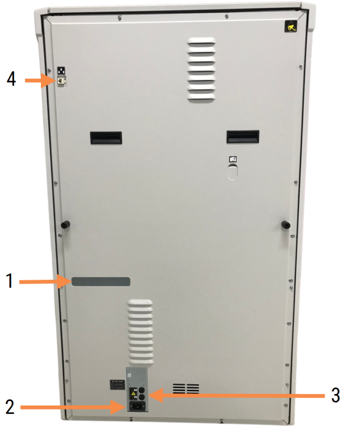
Şekil 2-24: BOND-III arka kapak
