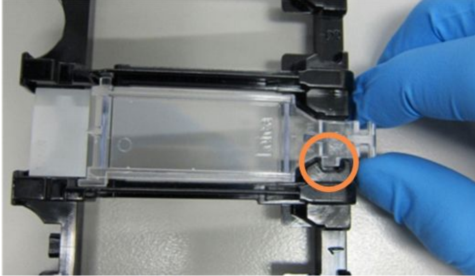
Şekil 4-6: Bir lam üzerinde Covertile'ın konumlandırılması
