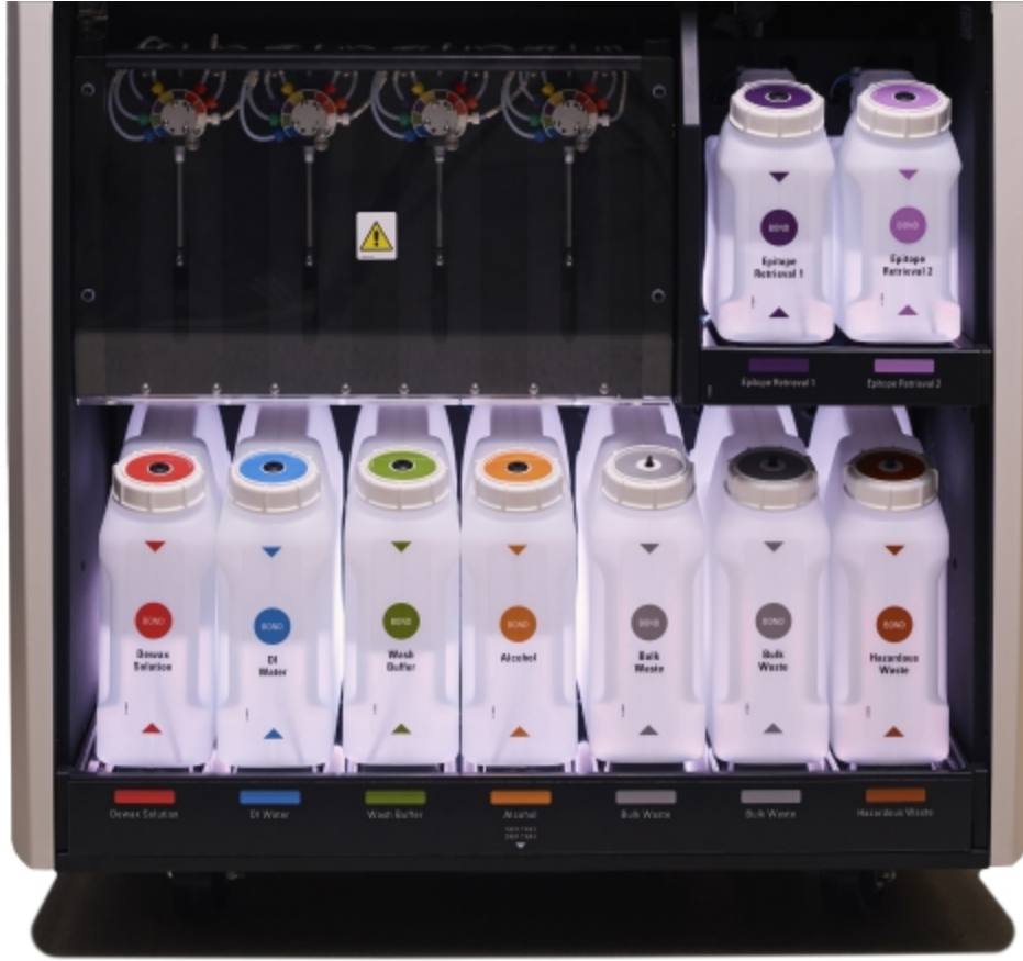
Şekil 2-15: Bidon aydınlatma sistemi
