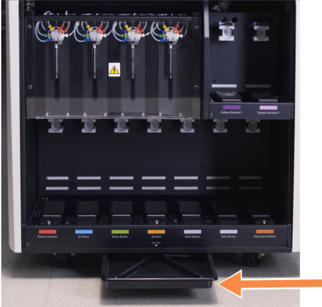
Şekil 12-14: BOND-III cihaz damlama tepsisi
