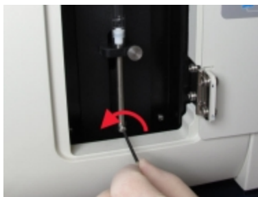
Сурет 12-17: Алты қырлы кілтпен поршеньді тежегіш бұранданы бұрау
